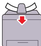
Sie können ungebundene Seiten mit dem automatischen Duplex-Dokumenteneinzug (DADF) scannen. Wenn Sie den DADF verwenden, legen Sie die bedruckte Seite nach oben ein.
